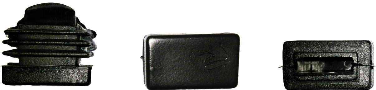
Figura 2: Peça de PP produzida com rebarbas.
