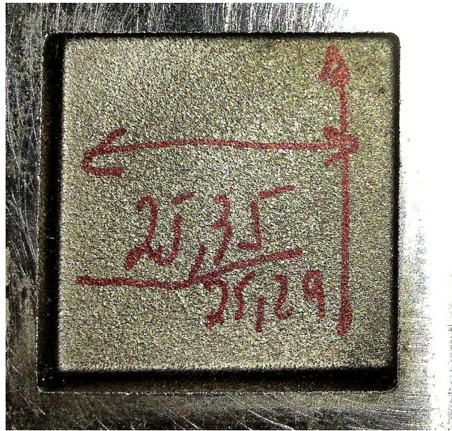
Figura 73: Resultado do ensaio com profundidade de 5 mm.
