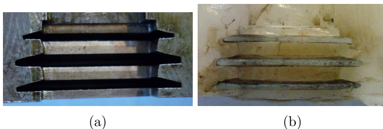
Figura 81: Resultados do ensaio de erosão com o elétron 2: a) Cavidade resultante; b) Peça moldada pela cavidade.
