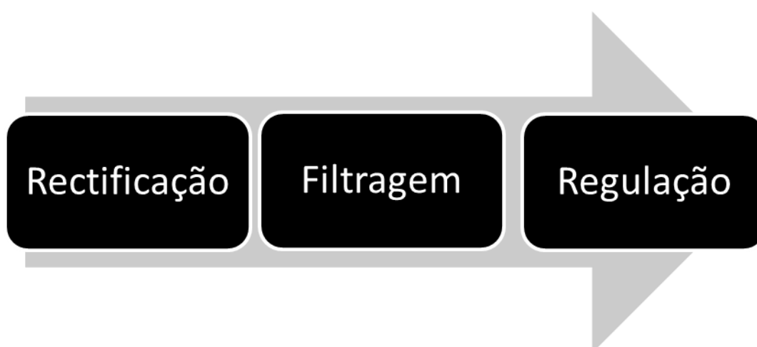
Figura 26 - Diagrama da transformação de Tensão AC em DC
