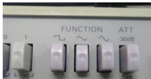
Figura 4 - Formas de ondas disponíveis no gerador de sinais
