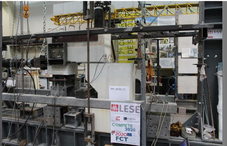
Estudo de ligações viga-pilar de estruturas pré-fabricadas de betão armado
