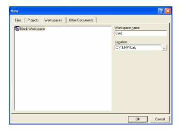
O projecto depois de criado possui três ficheiros (DoubleCalc.cpp; StdAfx.h; StdAfx.cpp). O ficheiro DoubleCalc.cpp contém a função main que deve ser substituída pelo seguinte código de forma a implementar a funcionalidade pretendida.
